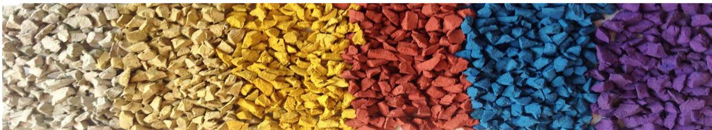
Для детских и спортивных площадок мы производим несколько видов травмобезопасных покрытий с богатой цветовой гаммой и различной толщиной покрытия – от 1 до 4 см. Также возможно устройство специальных «подушек безопасности» толщиной до 10 см. в зонах рисков. Покрытия укладываются методом наливных ковров, поэтому не имеют швов и могут быть уложены в любых труднодоступных местах подобно бетону, а технология укладки спортивного покрытия выглядит следующим образом:
